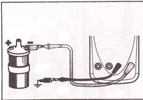
Sur les anciens véhicules, Il était très important de mesurer l'angle de fermeture du rupteur d'allumage. La mesure angulaire est la durée pendant laquelle le rupteur reste fermé pendant que la came tourne.
