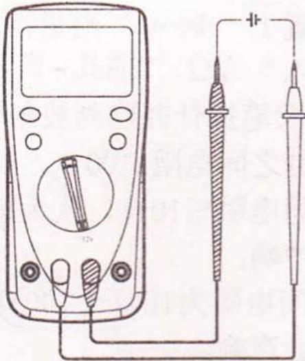
Mettre le commutateur en position 12V  $\text{V}$ .
