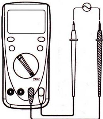
Mettre le commutateur en position 2kHz.
