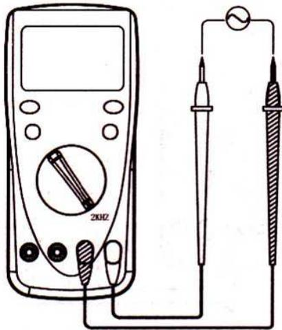
Mettre le commutateur en position 2kHz.
