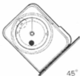
Aligner l'angle voulu avec l'échelle pivotante avec le zéro de l'échelle fixe.
