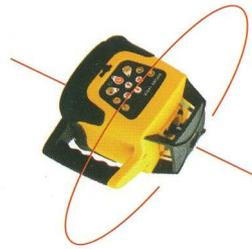
Quand l'instrument est bien nivelé , il émettra un rayon laser pour former une surface de balayage horizontal et une ligne à plomb automatiquement. quand l'ensemble est placé horizontalement, il formera une surface à plomb de balayage et une ligne verticale.
