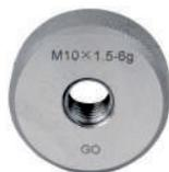
➤ Pour un contrôle "entre" de taraudage métrique ISO DIN13 pas normaux.
