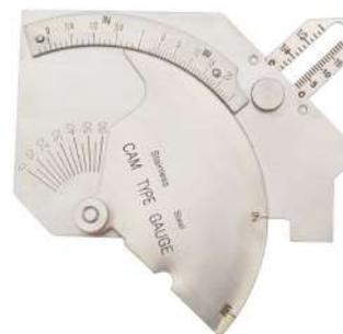
› Vous permet de mesurer en pouces ou en mm la hauteur du corbeau, la hauteur de la jambe de soudure d'angle, le désalignement haut-bas, la profondeur de contre-dépouille, la taille de la gorge de soudure d'angle, l'angle de préparation (chanfrein), la longueur de l'angle de 45°.
