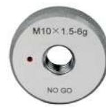
► Pour un contrôle "n'entre pas" de taraudage métrique ISO DIN13 pas normaux.
